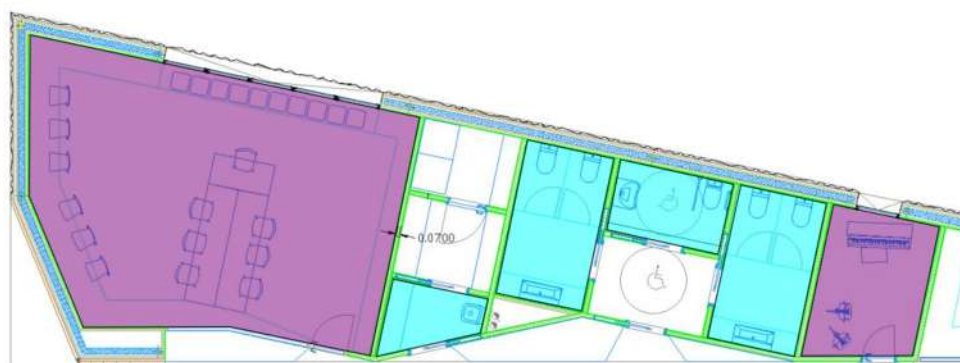
Figura 2. Selección de un grupo de habitaciones para ejemplificar la zonificación acústica de las mismas.
